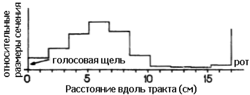
Рис. 1. Типичная функция поперечного сечения акустической трубы, применяемая в каскадном дискретном синтезаторе.
