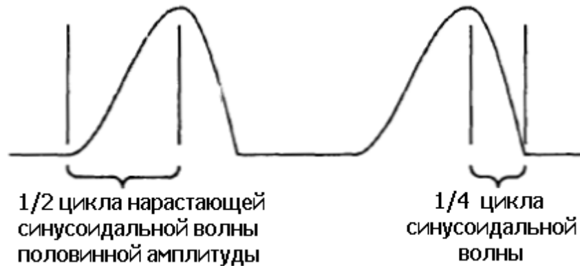
Рис. 18. Стилизованный импульс голосовой щели, составленный из синусоидальных сегментов.
