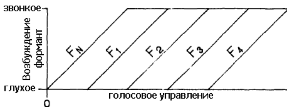
Рис. 21. Характеристики системы смешивания возбуждения в зависимости от изменения звонкости.
